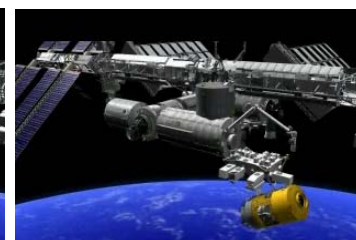
上:ハーモニー(第2結合部)天頂側に移設される「こうのとり」2号機(写真) / 下:地球側から天頂側への移設イメージ(CG)
