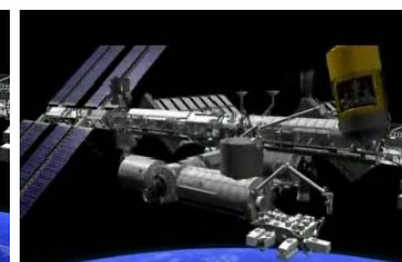
上:ハーモニー(第2結合部)天頂側に移設される「こうのとり」2号機(写真) / 下:地球側から天頂側への移設イメージ(CG)
