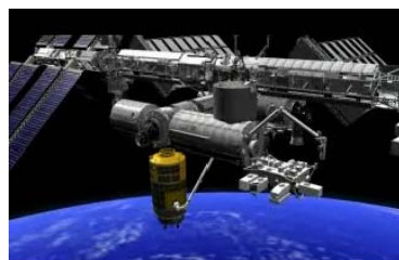
上:ハーモニー(第2結合部)天頂側に移設される「こうのとり」2号機(写真) / 下:地球側から天頂側への移設イメージ(CG)
