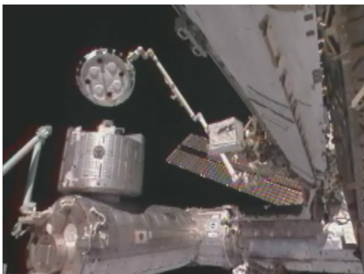
上:ハーモニー(第2結合部)天頂側に移設される「こうのとり」2号機(写真) / 下:地球側から天頂側への移設イメージ(CG)
