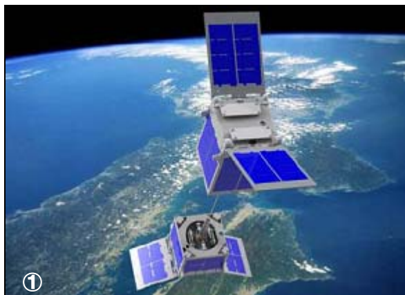
①【香川大学 | 「STARS II」】 重力傾斜を利用したテザー(ひも)の伸展や、テザー張力を利用したテザー宇宙ロボットの制御を行う。
