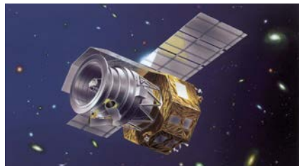
赤外線天文衛星「あかり」(2011年運用終了) 日本初の本格的な赤外線天文衛星で、空全体にわたって星や銀河などすべての赤外線源を調べあげる「サーベイ観測」を主な目的として運用された。
